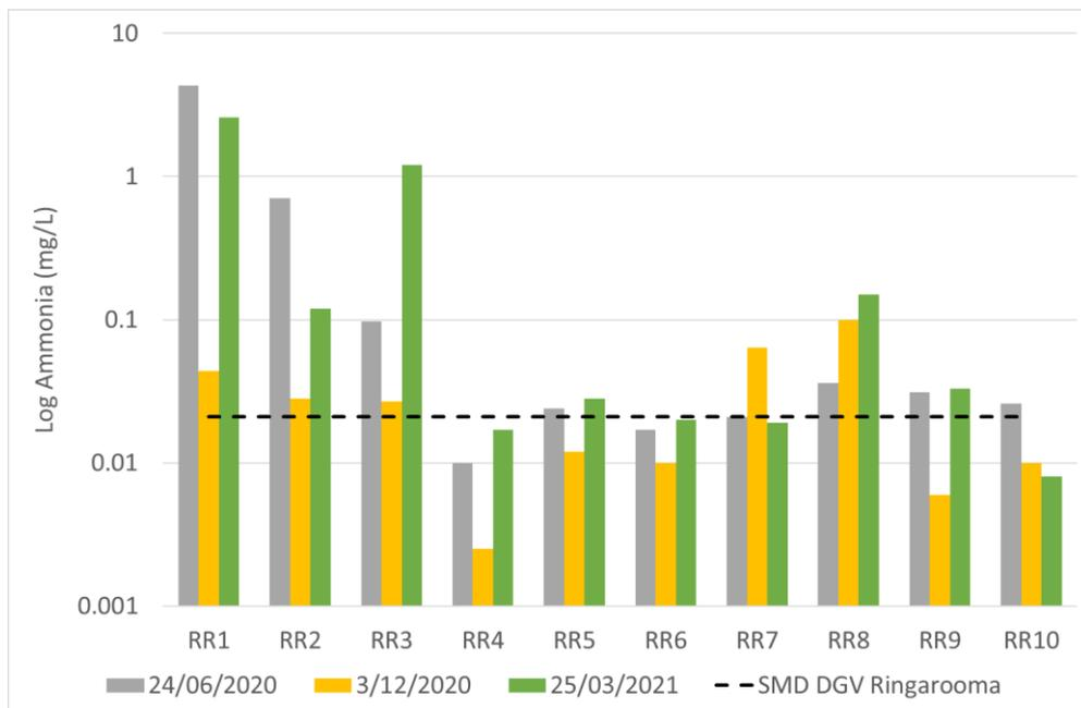
FIGURE 11. LOG AMMONIA (MG/L) AT MONITORING SITES VERSUS THE SLIGHT TO MODERATELY DISTURBED DEFAULT GUIDELINE VALUE FOR THE RINGAROOMA RIVER
